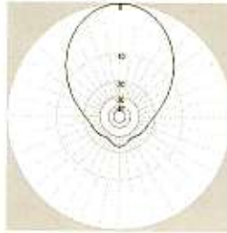
Fig. 4. Horizontaal stralingspatroon van de biquad.
